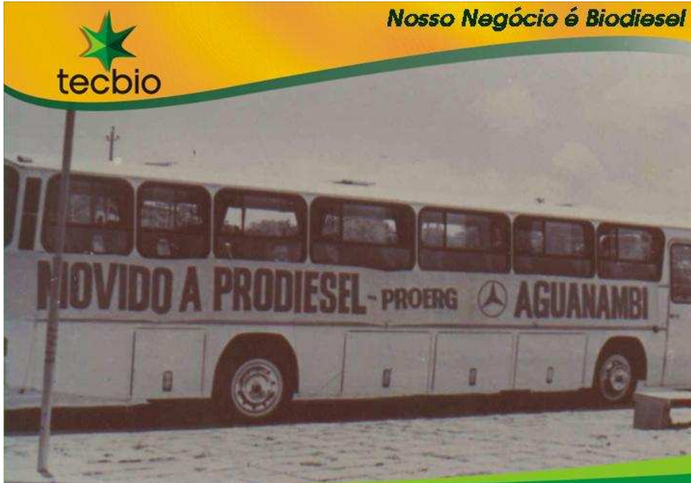
PRIMEIRO ÔNIBUS FUNCIONANDO COM BIODIESEL PURO - UM MONOBLOCO DA MERCEDES-BENZ (Outubro de 1980)
