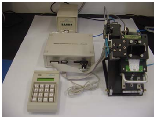
Figura 1: Foto do sistema de teste para displays de celulares
