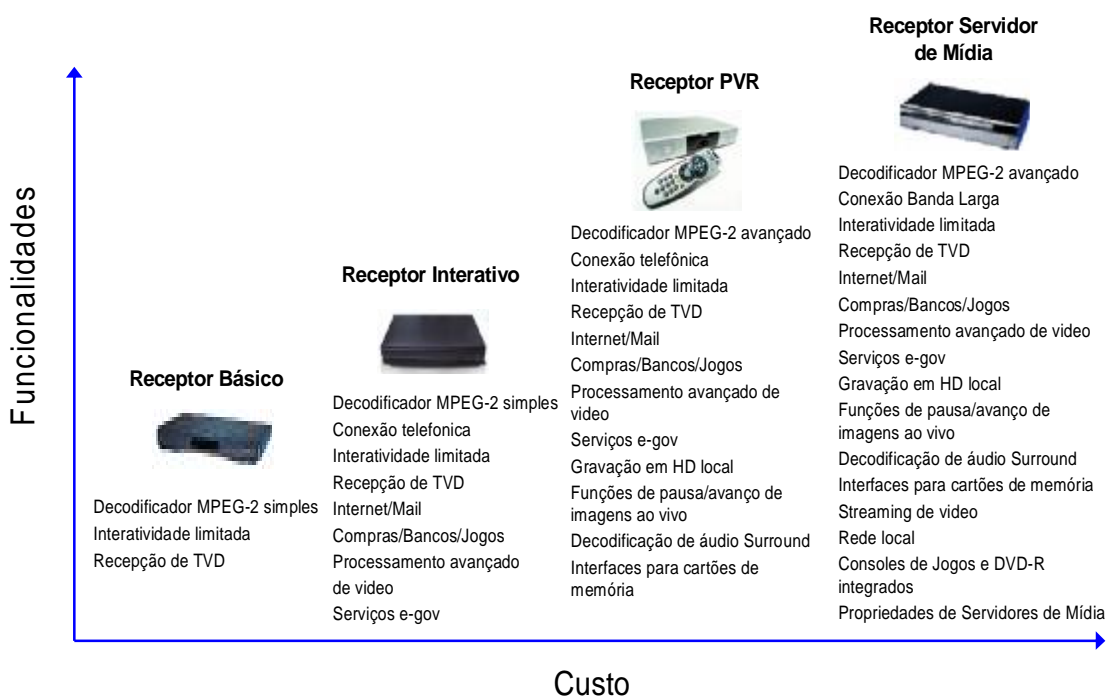
Figura 21: Evolução do Set Top Box de TV Digital
