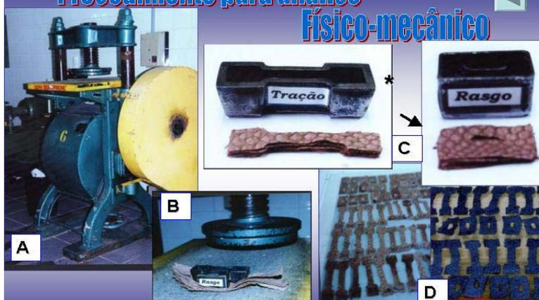
Figura 1 – (A) Balancim; (B) Corte dos corpos-de-prova; (C) navalhas de corte para obtenção dos corpos-de-prova para determinação da tração e alongamento (\*1) e rasgamento progressivo (seta); (D) Corpos-de-prova em aclimatação
