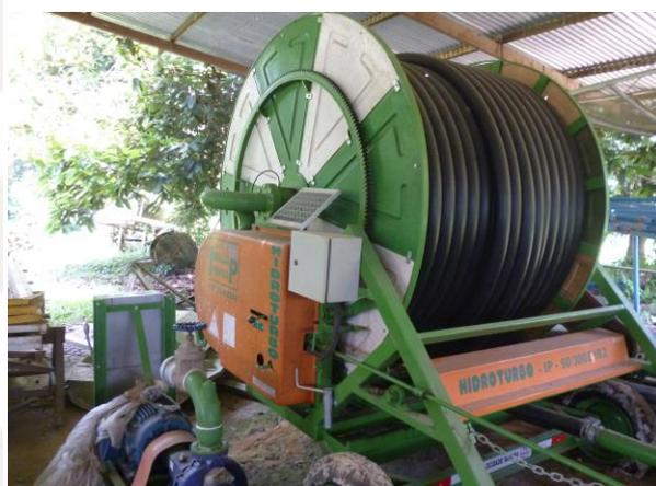
Figura 16 – Equipamento de irrigação, tipo carretel
