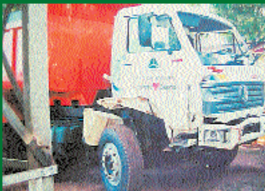
4 - Caminhão Basculante Potência 142 a 160cv
